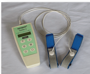
fig. 3 e 4 – apparecchio, cavo di collegamento e polsini/elettrodi adesivi
