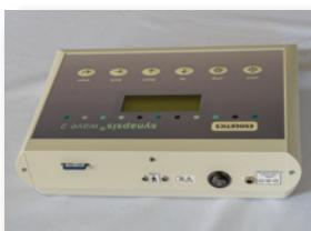
Das Gerät speichert die zusätzlichen Programme. Entnehmen Sie die SD Karte aus dem Gerät. Durch leichtes drücken kommt durch den Federmechanismus die SD Karte aus dem Gerät (Abb. 11).
